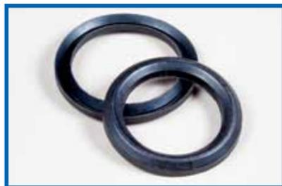
Уплотнения шевронные резиноканевые предназначены для уплотнения штоков и цилиндров гидравлических устройств диаметром до 2000 мм, работающих при давлении до 63 МПа со скоростью возвратно-поступательного движения до 3 м/с в среде минеральных масел, нефти, пресной и морской воды, в одних эмульсий при температуре от -50°C до +100°C (кратковременно до +120°C)
