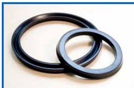
**Манжеты резиновые применяются** для уплотнения зазора между цилиндром и поршнем (плунжером, штоком) в гидравлических устройствах, работающих в условиях возвратно-поступательного движения со скоростью относительного перемещения не более 0,5 м/с, при давлении от 0,1 до 50 МПа, температуре от -60°C до +100°C, ходе до 10 м и частоте срабатывания до 0,5 Гц.
