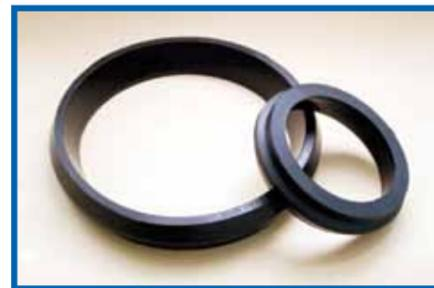
Кольца сечением «1-Б-1», «1-Б-2», «БХ», «Б-2» применяются для чугунных напорных труб диаметром 65-400мм, предназначенных для работы в системах водоснабжения. Работоспособны при температуре от -20°С до +50°С, при давлении 1,6 МПа.
