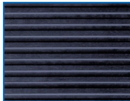
Ковры резиновые диэлектрические применяются в качестве дополнительного защитного средства в закрытых электроустановках напряжением свыше 1000 В, кроме особо сырых помещений, а также в открытых электроустановках в сухую погоду. Изделия выдерживают напряжение 20 кВ переменного тока, частотой 50 Гц.
