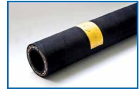
Рукава резиновые с нитяным усилением применяются в тормозной системе подвижного состава железных дорог и метрополитена для подачи воздуха под давлением до 1 МПа. Работоспособны в любых климатических районах при температуре от -55°С до +70°С.
